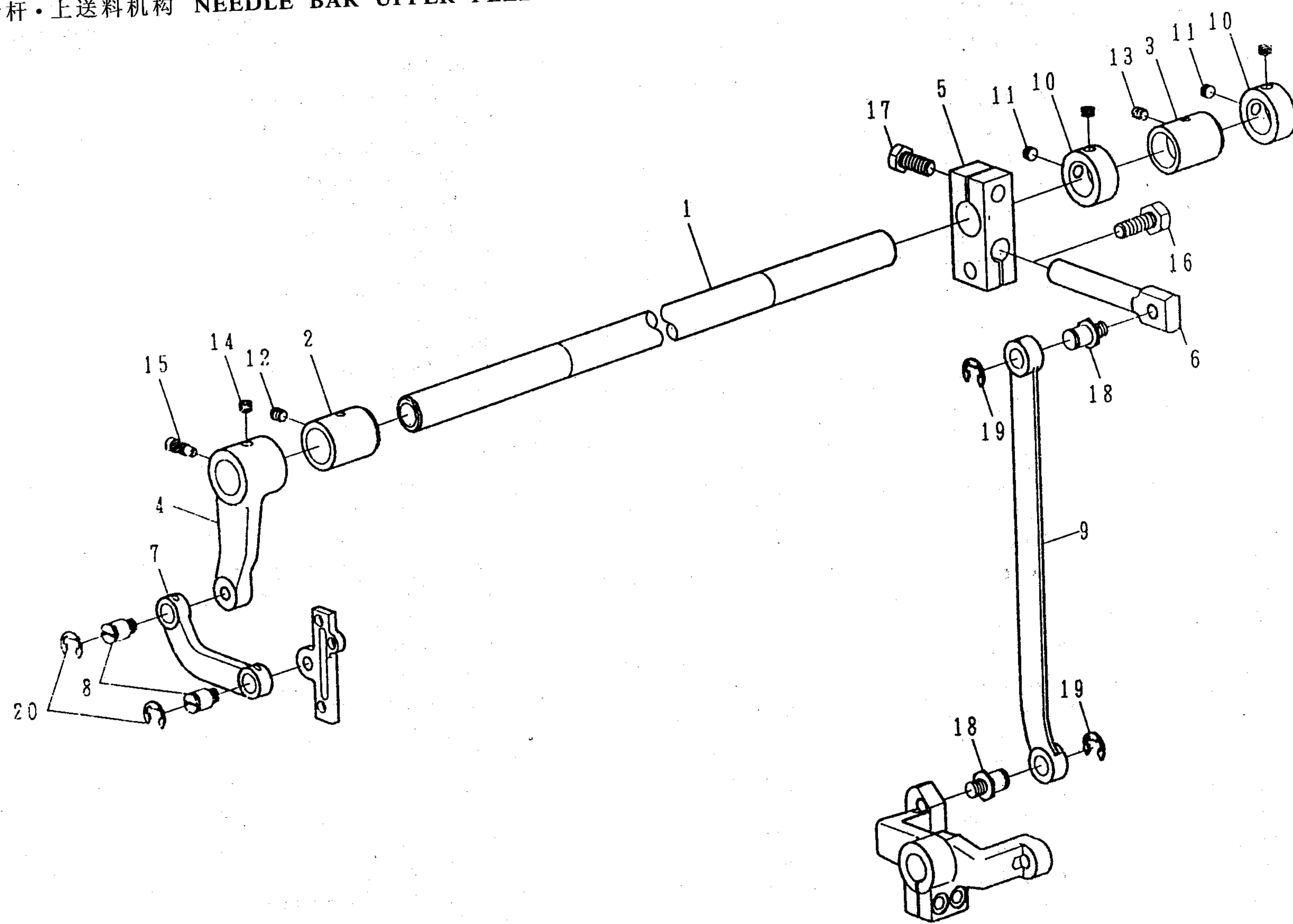
C. 针杆 上送料机构 NEEDLE BAR • UPPER FEED MECHANISM COMPONENTS (GA-441-1)
