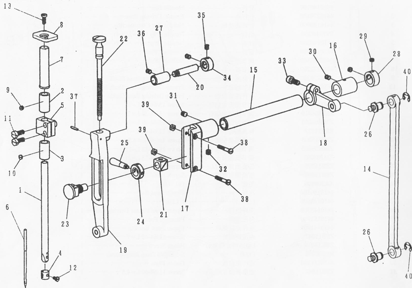
C. 针杆 上送料机构 NEEDLE BAR UPPERFEED MECHANISM COMPONENTS(GA-471-1)
