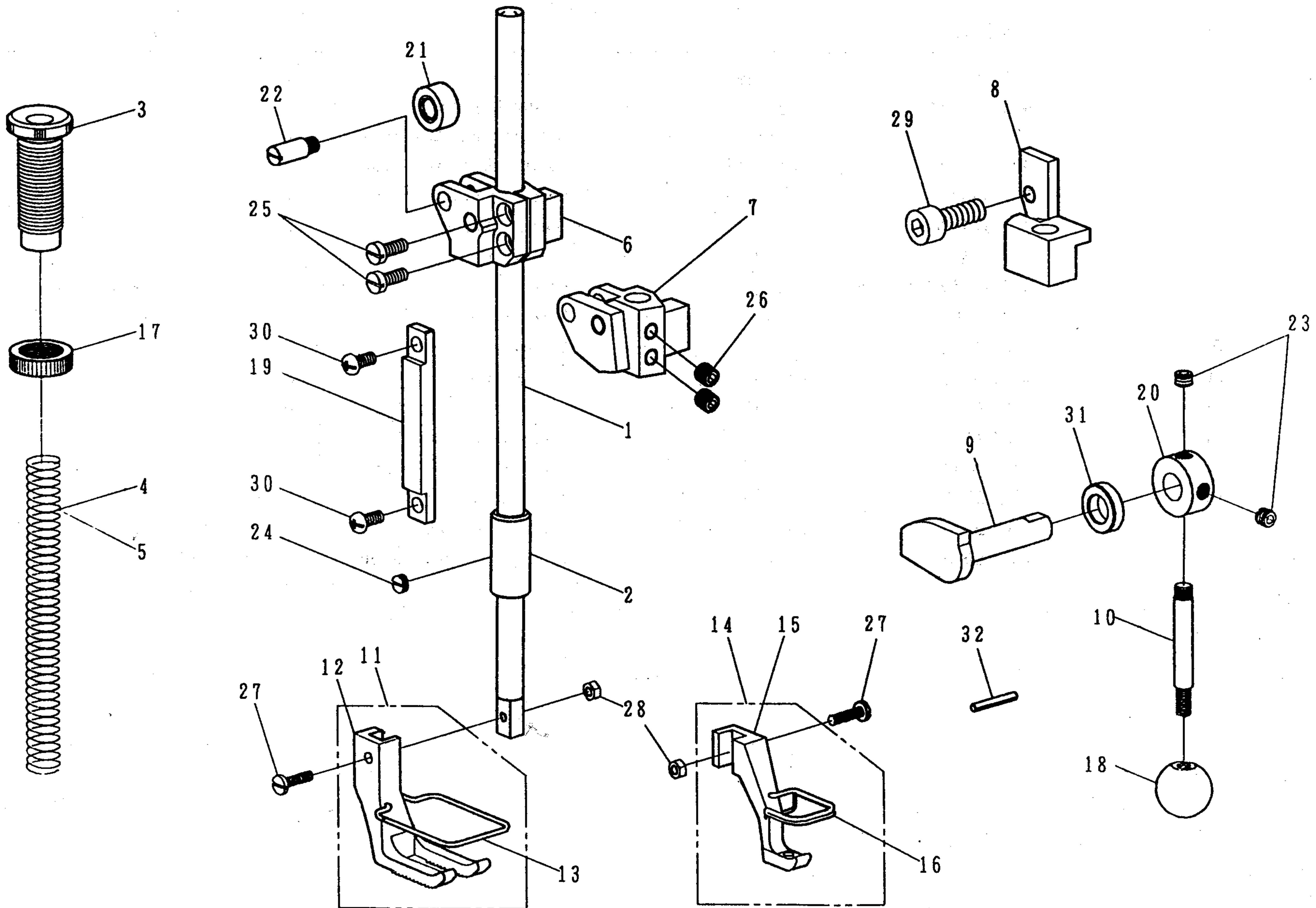
D. 压轴机构 PRESSURE BAR COMPONENTS
