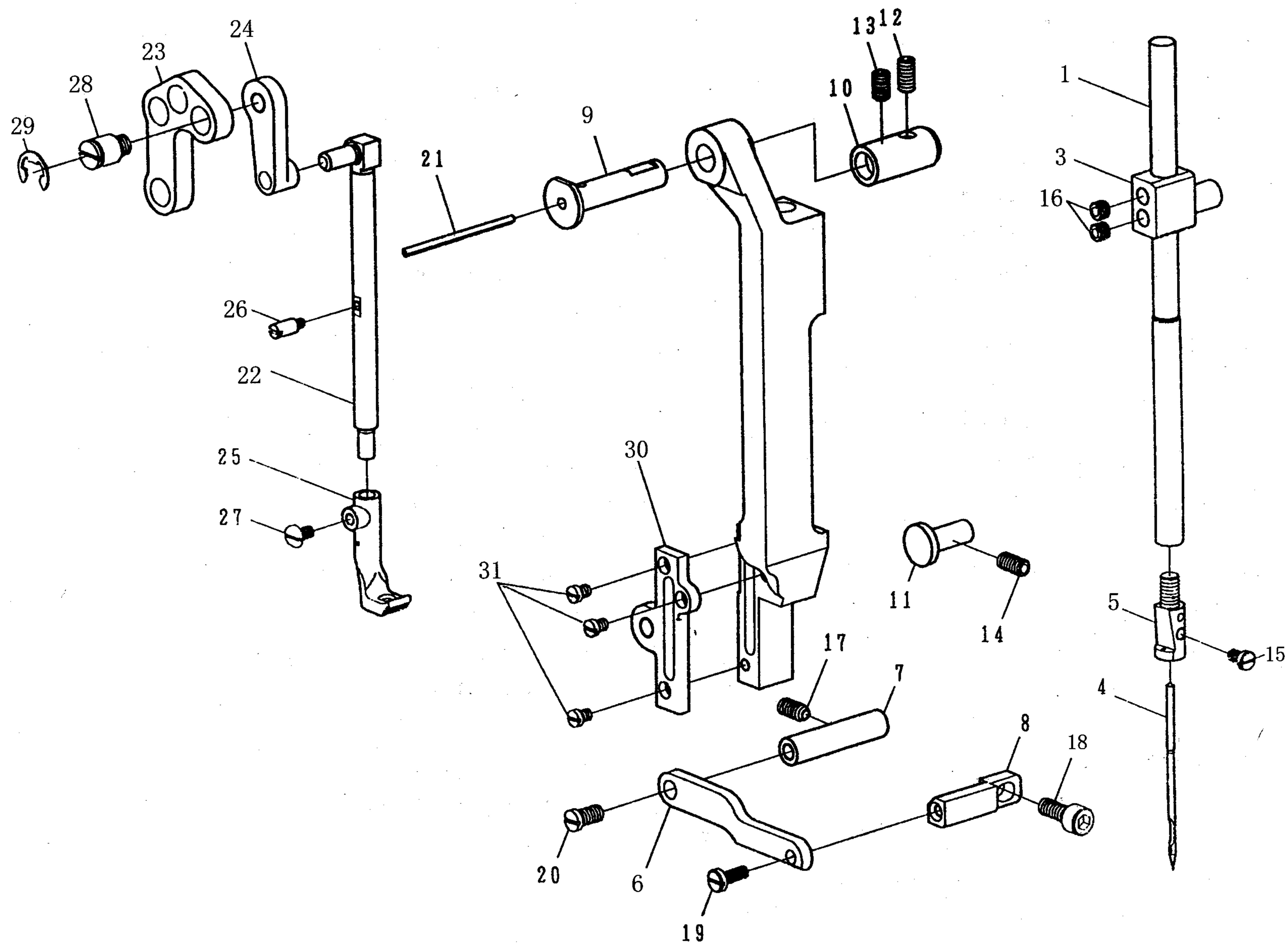
B. 针杆. 上送料机构 NEEDLE BAR UPPER FEED MECHAISM COMPONENTS (GA441-2)
