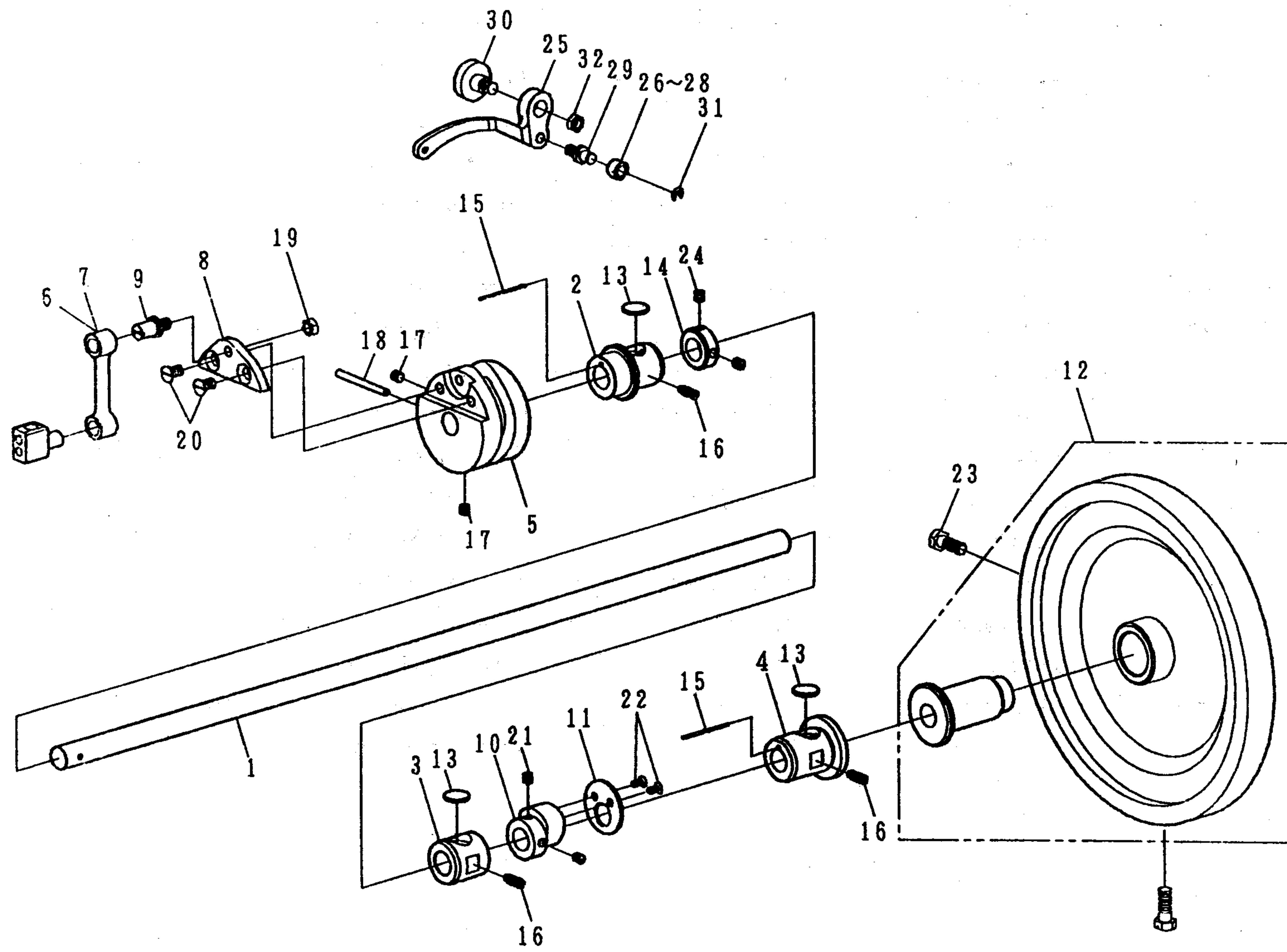
B. 上轴机构 MAIN SHAFT COMPONENTS
