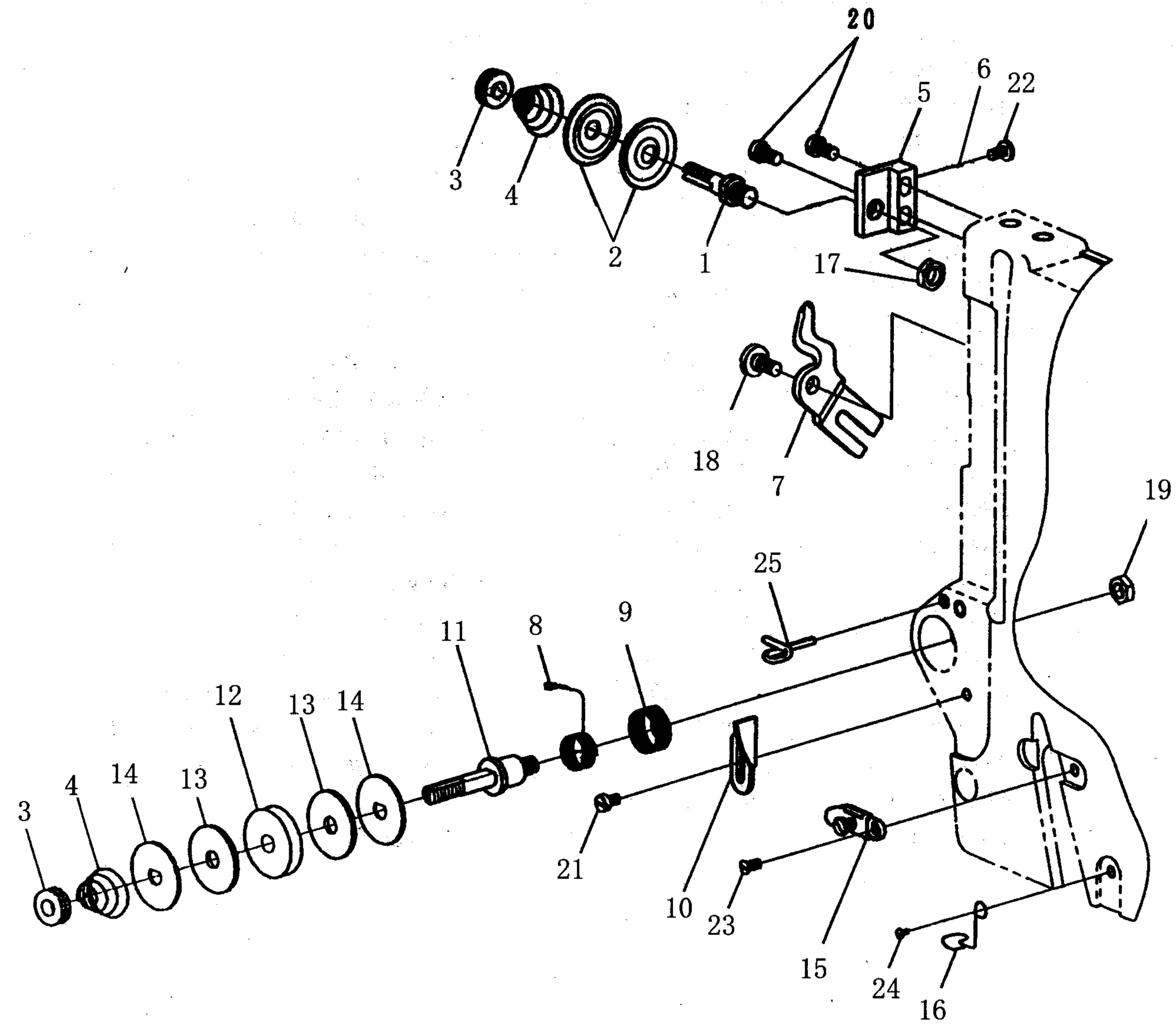
**G. 夹线机构 TENSION POST COMPONENTS**
